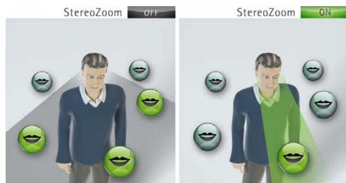
Fig. 1: Les microphones directionnels monauraux ont un angle de focalisation avant large (faisceau gris) qui améliore l'audibilité de tous les sons compris dans le faisceau (à gauche). StereoZoom crée un faisceau beaucoup plus focalisé vers l'avant (faisceau vert) pour se concentrer sur une seule voix dans une foule (à droite).
